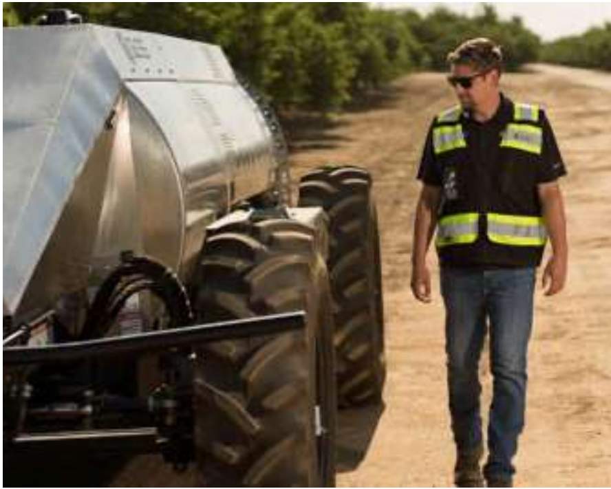
Chaleco de seguridad Defender™ de GUSS para la pausa de la máquina al detectar una persona.
