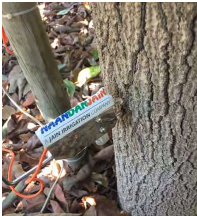
Dendrómetro en tronco.
