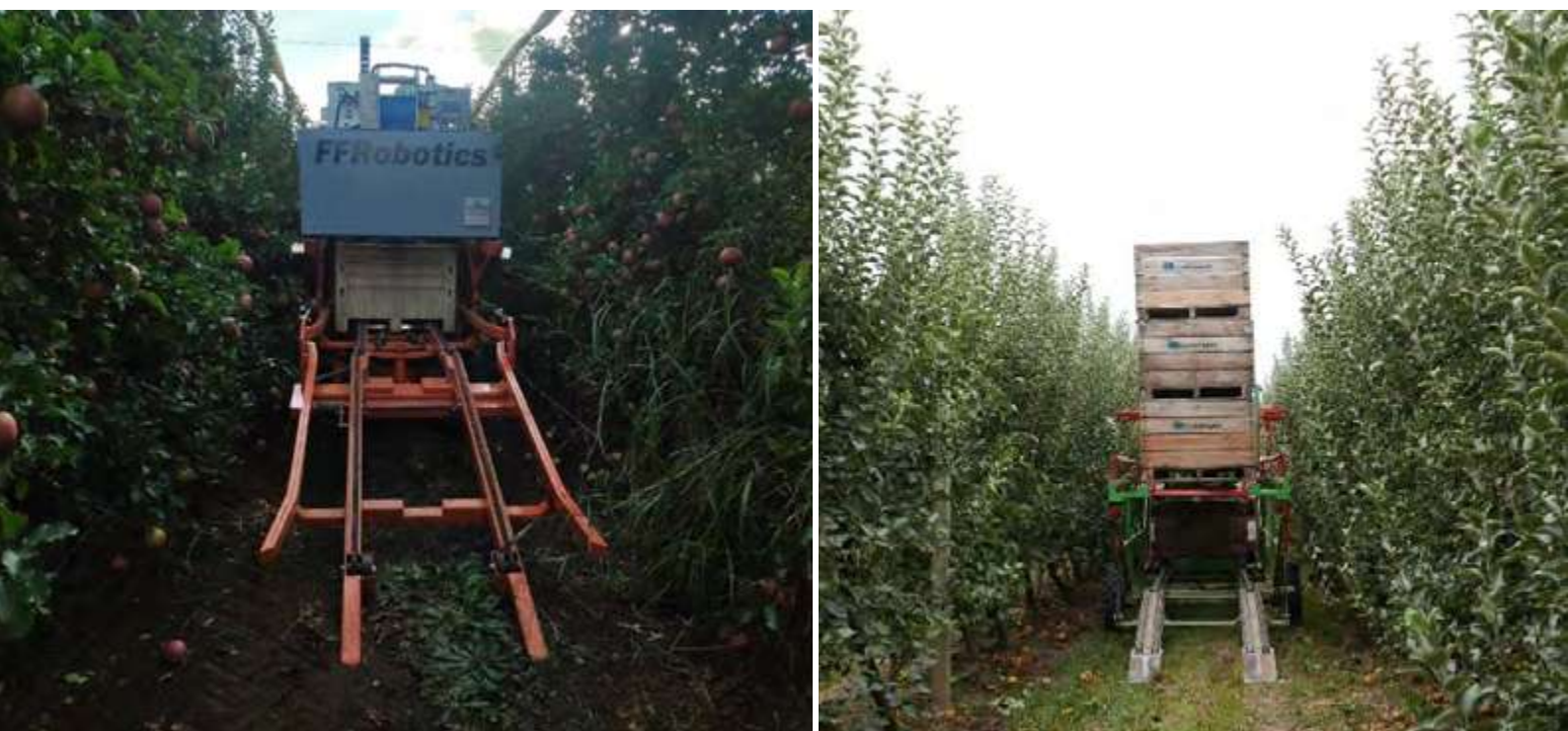
Figura 5. A la izquierda vista posterior del FFRobot donde se observa la salida y descarga de los palots una vez llenos. A la derecha puede observarse su similitud con una plataforma convencional (Foto: I. Iglesias).
