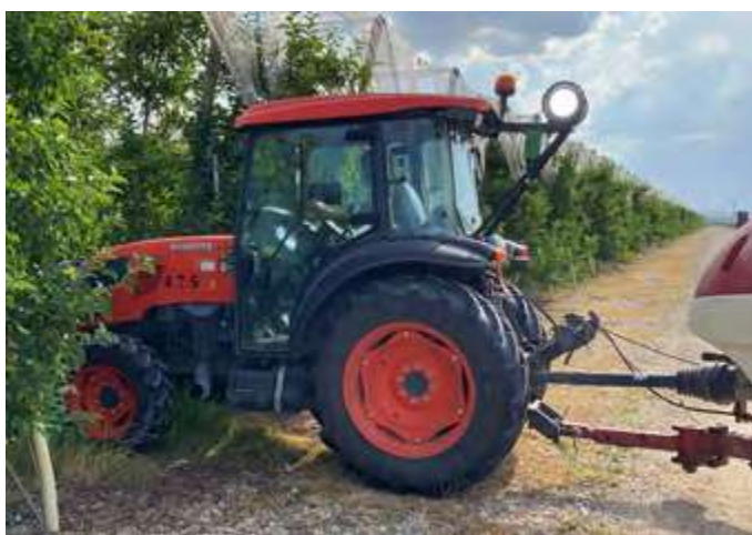
Tractor equipado con el equipo OnFruit 360 de Agerpix captador de imágenes para el aforo de cosecha, al mismo tiempo que realiza el tratamiento fitosanitario en plantación de manzano.
