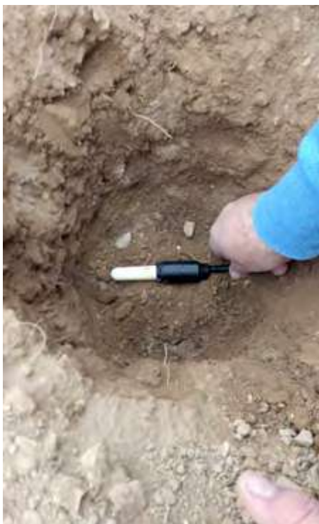
Sensor de potencial hídrico sin agua.
