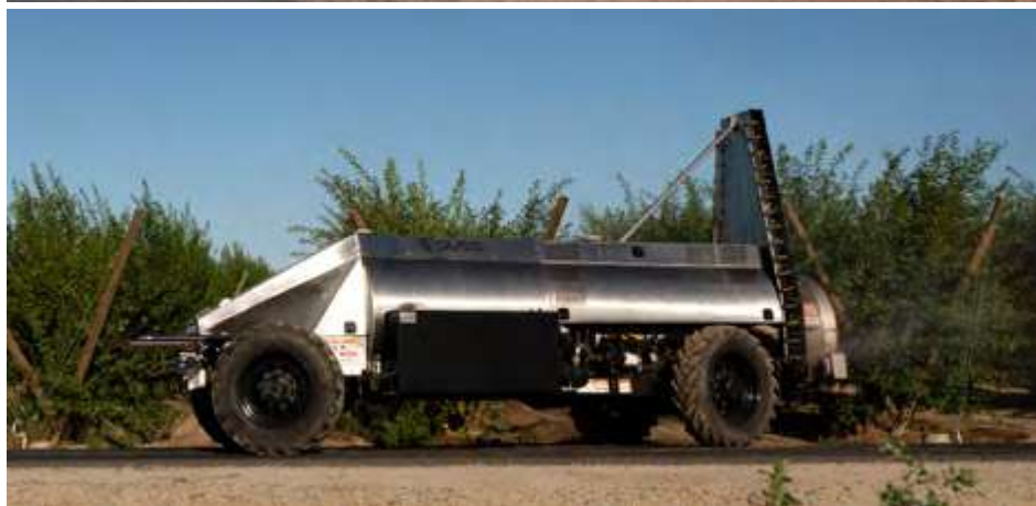
Vista lateral del pulverizador autónomo Mini GUSS con una longitud total de 6 m y torre con 44 boquillas.
