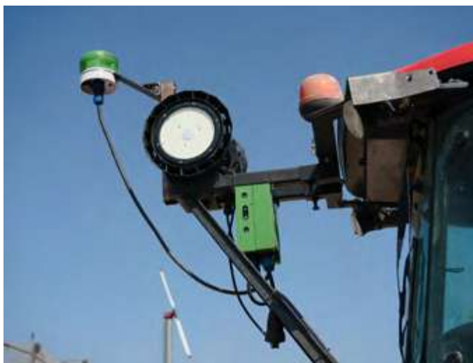
OnFruit 360: sensor plug&play, rápido y fácil de instalar, operable por el fruticultor en un vehículo de su flota (tractor u otro).
