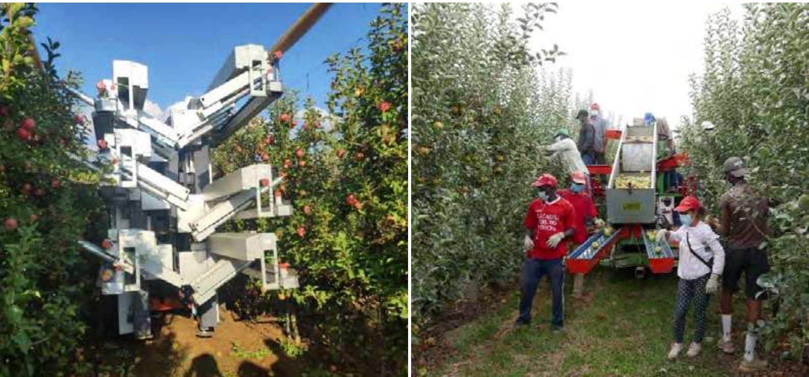
Figura 4. El recolector FFRobot en pleno trabajo de campo con sus 12 brazos robóticos recolectores independientes. Pueden observarse las cintas de descarga de las manzanas en tres niveles de altura
