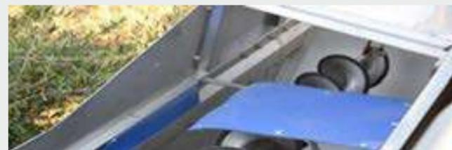
Ilustración 4: adaptación de la máquina para evitar el choque de las aceitunas contra el tornillo sinfín de las tolvas (fuente Xavier Rius).
