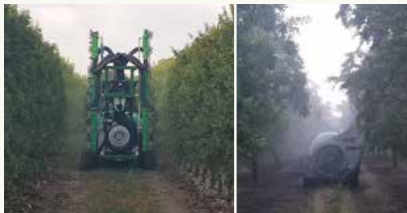
Figura 6: Los dos tipos de pulverizadores realizando los ensayos en julio de 2021. A la izquierda el Fede High Density y a la derecha el John Deere R-130 en vaso intensivo.
