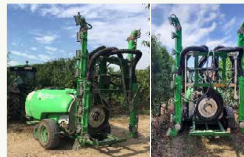
Figura 4. Prototipo de pulverizador Fede High Density utilizado en el tratamiento de la parcela superintensiva. Fuente: GRAP-UdL/Agrotecnio-CERCA Center.
