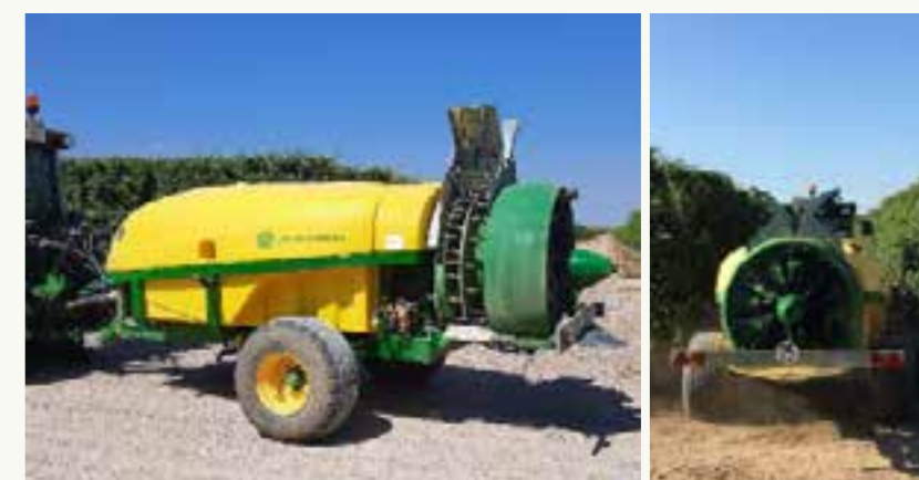
Figura 5. Pulverizador John Deere R130 utilizado en el tratamiento de la parcela intensiva accionado por un tractor John Deere 5105 GF. Fuente: GRAP-UdL/Agrotecnio-CERCA Center.
