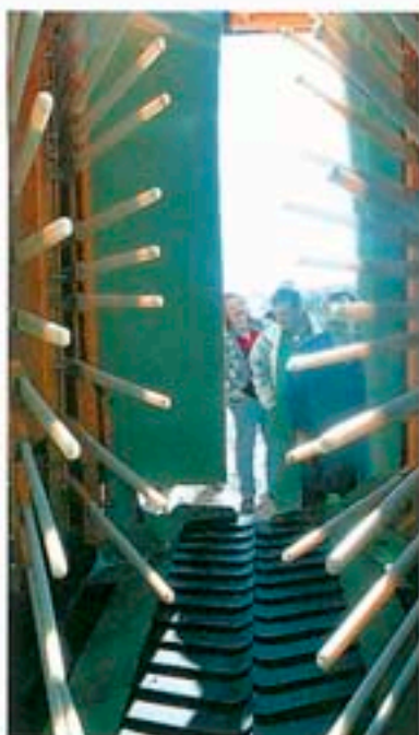
Detalle de los sacudidores y escamas recogedoras del interior de la máquina
