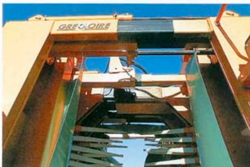
Detalle del sistema de ancho variable de la Gregoire G133v.
