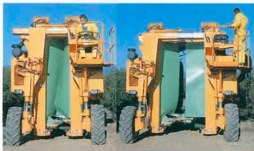
Frontal de la Gregoire G133v en su mínimo (izq) y máximo (der) ancho de trabajo.
