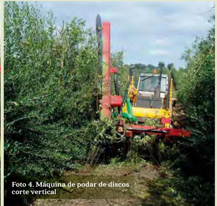
Foto 4. Máquina de podar de discos corte vertical
