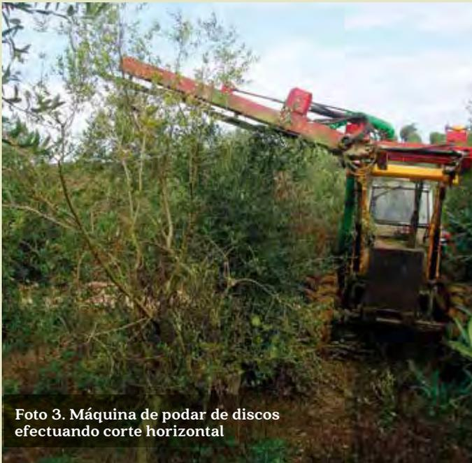
Foto 3. Máquina de podar de discos efectuando corte horizontal
